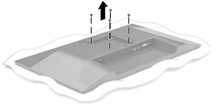
2. Um den Monitor an einem Schwenkarm oder einer anderen Montagevorrichtung anzubringen, führen Sie vier Befestigungsschrauben durch die Bohrungen an der Montagevorrichtung in die VESA-Schraublöcher an der Rückseite des Monitorkopfes.
