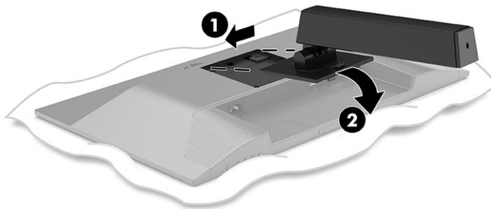
Der Entriegelungsschieber an der Unterseite der Montageplatte wird gelöst, wenn der Standfuß eingerastet ist.
